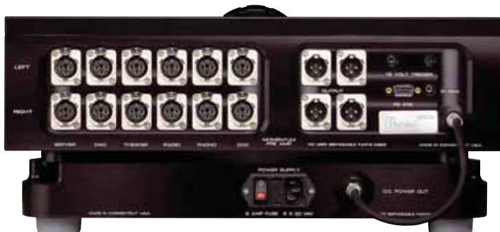
Für den Signalanschluss gibt's ausschließlich XLR-Buchsen. Wer unsymmetrisch anschließen will, muss mit Adaptern arbeiten
