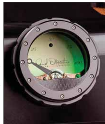
Am Zeigerinstrument der Vorstufe kann man die Stellung des Pegelstellers zumindest abschätzen
